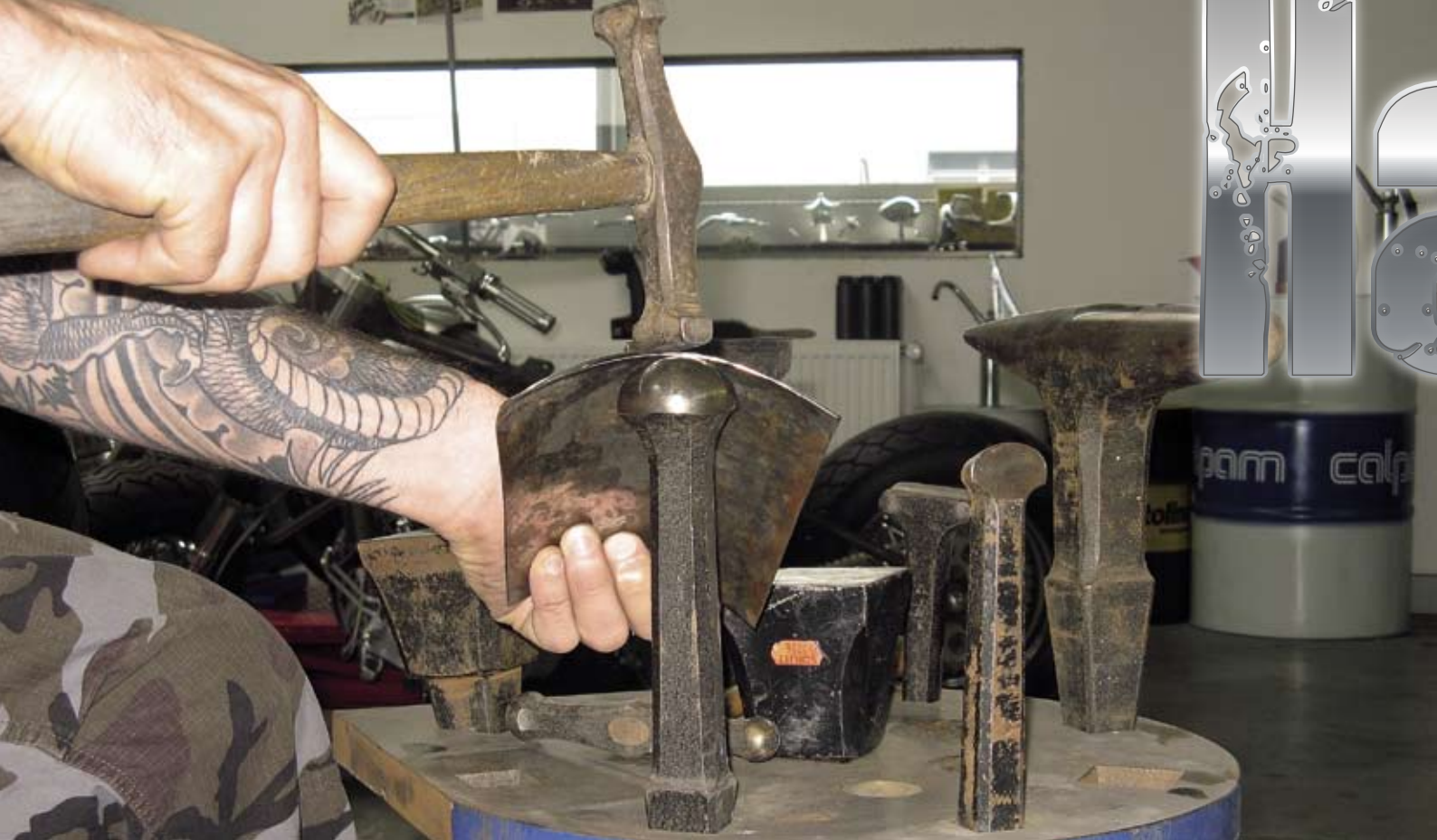
Hier wird von Hand gedengelt. So lassen sich Wölbungen und Rundungen formen
