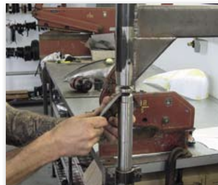
Grobe Arbeiten erleichtert die selbstgefertigte Dengelmaschine
