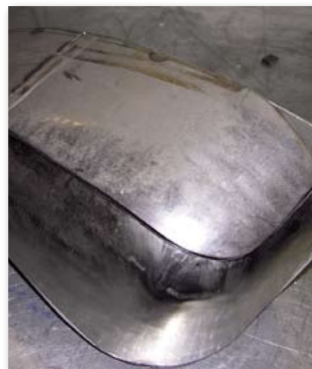
Das Werkstück findet sich schließlich als Segment in der Außenkante des Tanks wieder
