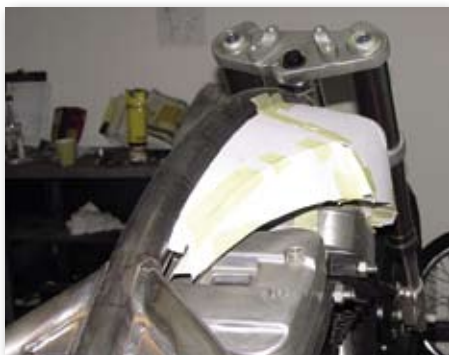
Am Beginn der Arbeit steht das Anpassen einer Attrappe aus Papier-Segmenten
