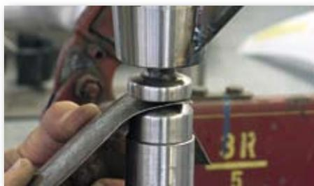
Verschiedene Formteile in der Dengelmachine ermöglichen verschiedene Wölbungsgrade
