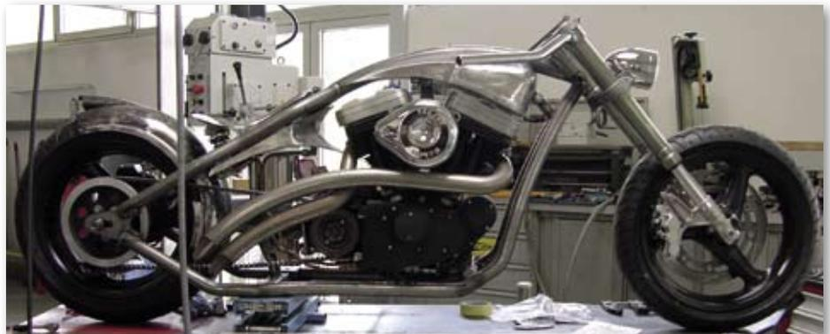
**Fertig! So schön kann ein Buell-Motor verbaut werden. Er wurde allerdings auf Vergaserbetrieb umgerüstet. Einspritzanlagen erfordern eine Menge Innereien an Pumpen und Filtersystemen, die sich in einem Custom-Tank nicht so einfach unterbringen lassen**
