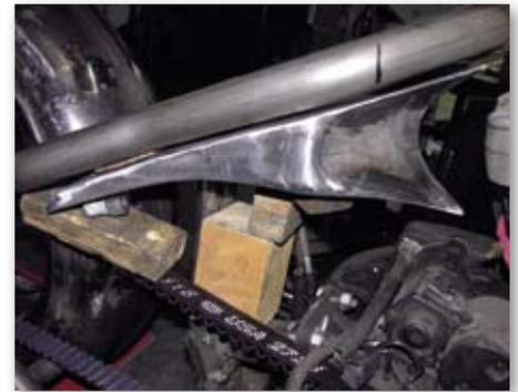
**Ausgefallene Formen bevorzugt. Hier der Öltank des gleichen Projekts. Sogar die Anschlusssteile sind in diesem Fall Eigenbauten**
