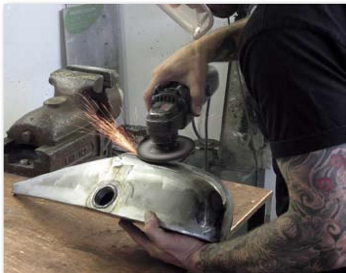
**Die Flex entfernt grobe Unebenheiten vom Tankrohling**
